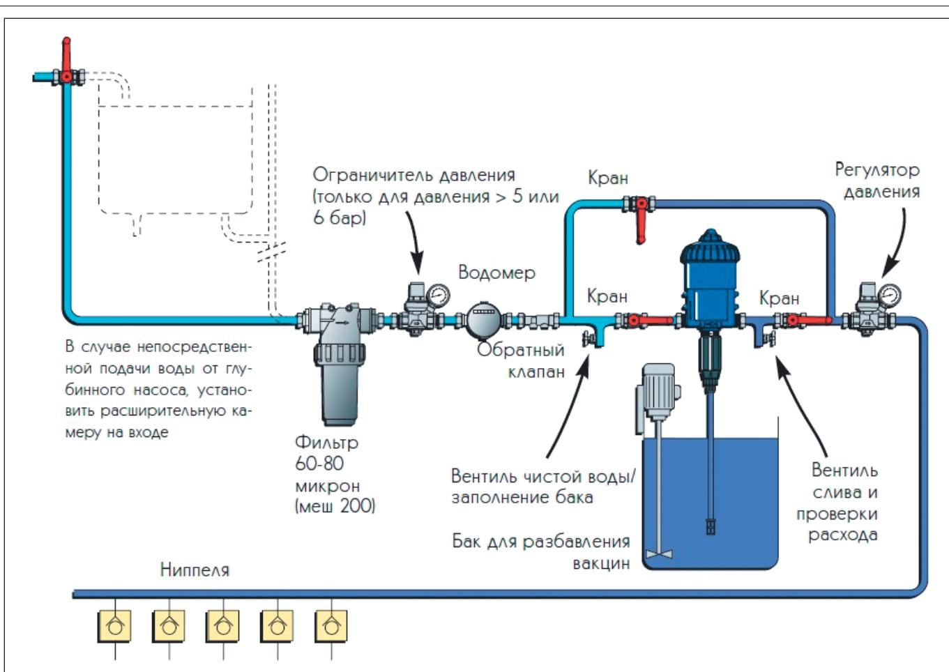
Рис. 3. Схема установки дозатора в сеть водоснабжения
