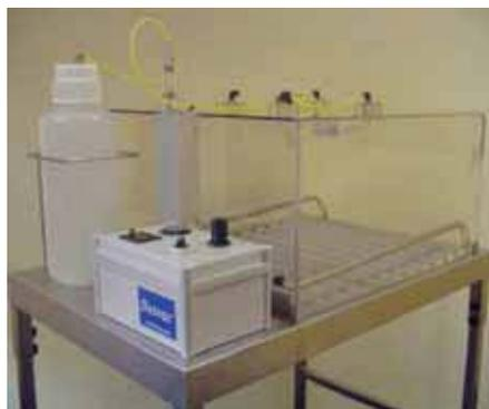
и распыляют на птиц точную дозу вакцины. Функционирование установки обеспечивается пневмосистемой, что сокращает проблемы и риски, возникающие при работе во влажной среде. Роликовая система помещает пластиковые ящики в нужное положение автоматически. Время опрыскивания может быть задано в соответствии с вашими требованиями. Счетчик, установленный в блоке управления, фиксирует количество обработанных ящиков.
