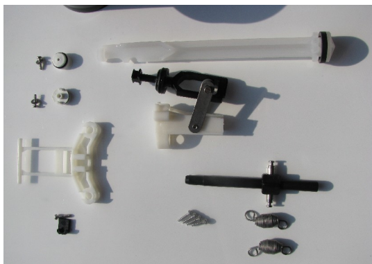
Деталировка поршня D25. Количество деталей 25 шт.
